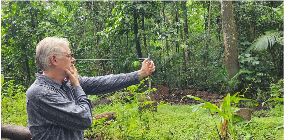
**Fig. 1.1.** Como posicionar o mirador BAF corretamente. Posicionar na altura dos olhos e utilizar o cordão para que o aparelho fique na distância correta do rosto. O cordão deve ficar completamente esticado. Foto: Vanessa Mariano da Silva - Conservation International.
