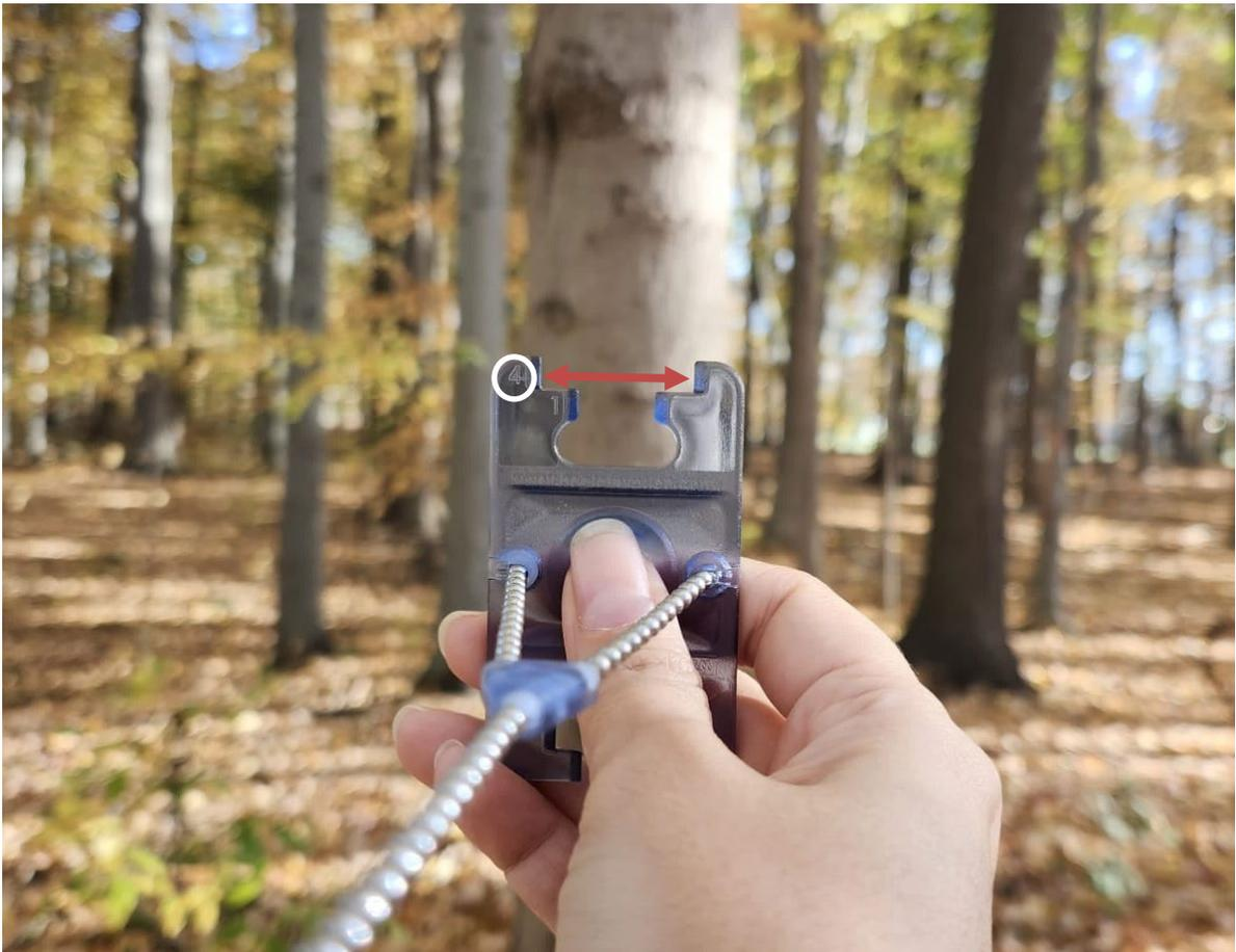
**Fig. 1.1.** Imagem de um mirador BAF (também chamado de gauge) sendo utilizado em campo. A seta laranja representa a medida de diâmetro que deve ser considerada para o medidor BAF 4 (ver o número 4 à esquerda, ressaltado pelo círculo branco, no topo do mirador). Foto: Vanessa Mariano da Silva – Conservation Internacional.
