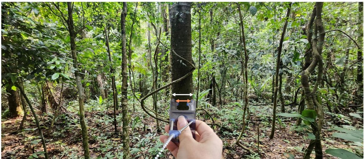
**Fig. 1.2.** Exemplo de utilização do BAF para selecionar árvores que serão contadas ou medidas. Na foto, a seta laranja representa o medidor do BAF e a seta branca representa o diâmetro da árvore. Nesse caso, o diâmetro da árvore (seta branca) é maior que o medidor (seta laranja), portanto a árvore está incluída
